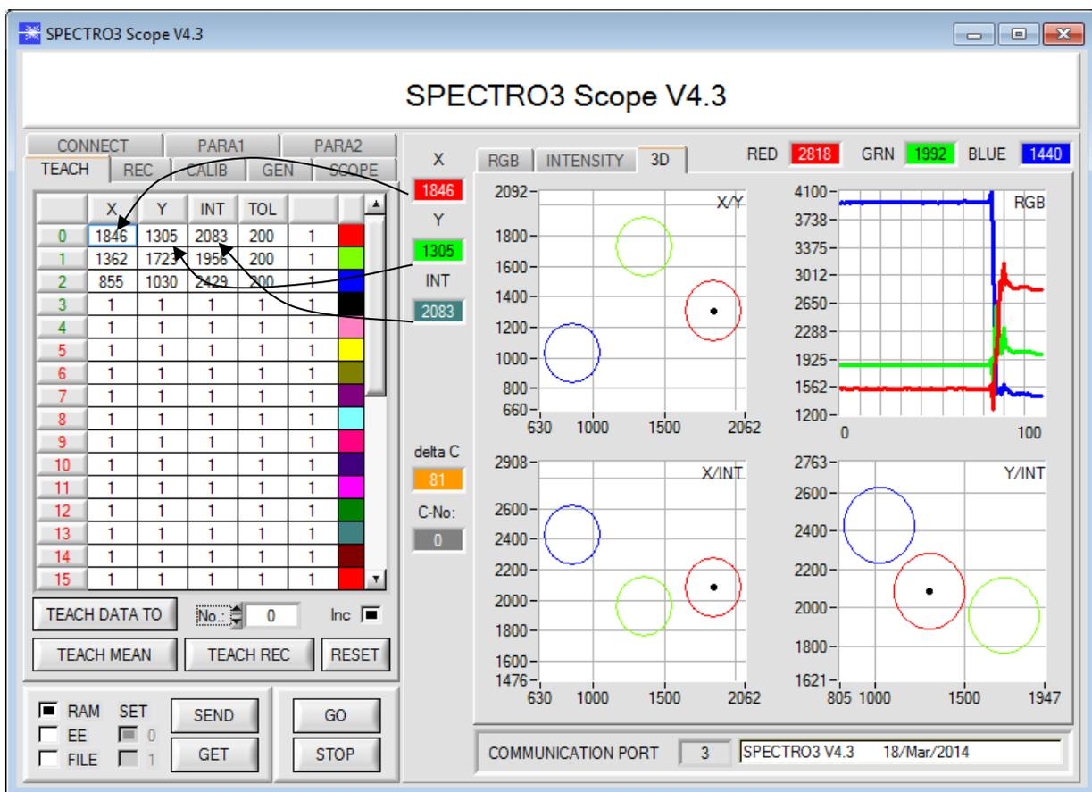
Drücken Sie nun wieder die Taste **SEND**, um dem Sensor die gelernte Farbe mitzuteilen. Aktivieren Sie den **GO** Modus wieder. Wenn der Sensor einen Zeilenvektor wiedererkennt (Farbe), wird die entsprechende Zeilennummer unter **C-No:** auf der Software-Oberfläche visualisiert. Der Wert 255 bedeutet, dass keine der gelernten Farben wiedererkannt wurde.
